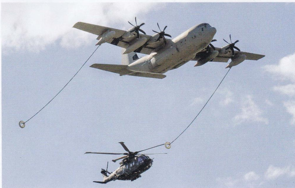
Un KC-130J della 46ª Brigata Aerea rifornisce un EH101.
